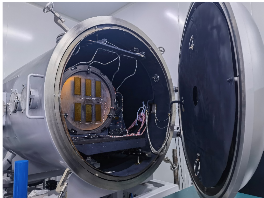
连接热管与冷板，复测系统，检查就绪后关闭罐门
