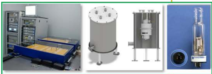
可见光定标系统系统 (LFC, FPU, ThAr)
