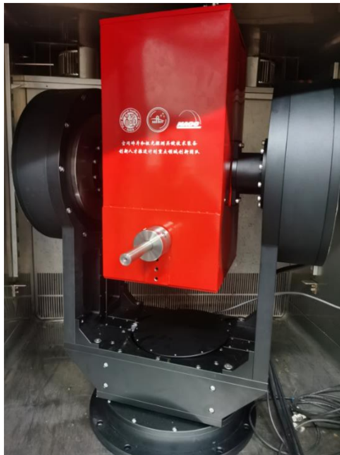
-80°C低温测试中的耐低温直驱电机转台
