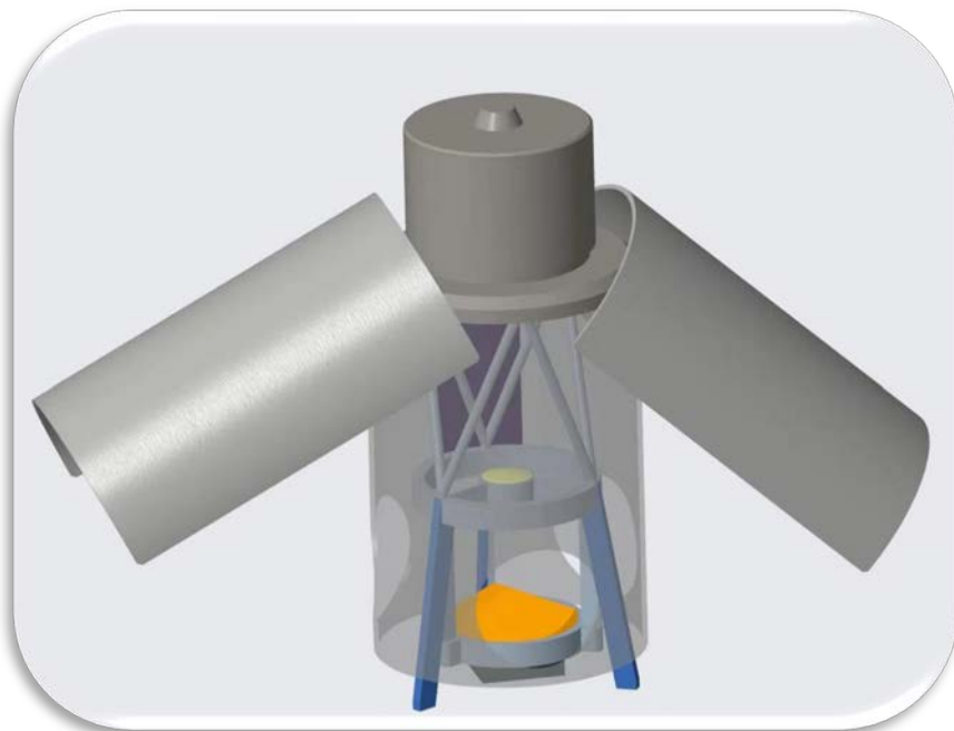
太阳能电池板展开观测状态
