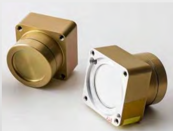
1英寸溴化镧晶体（北玻院） 1英寸PMT-R1924A（滨松）
